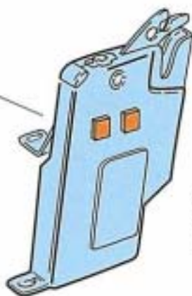
Verdeckkastendeckelschloß mit einer elektromotorischen Entriegelung
